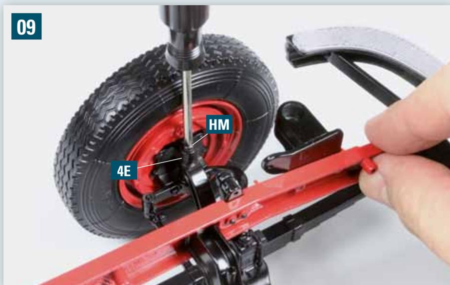
Jetzt werden der linke Achsschenkel 4E und das Vorderrad wieder zurückgeschwenkt und an der Vorderachse fixiert. Zunächst wird an der Oberseite des Achsschenkels eine Schraube HM festgezogen.
