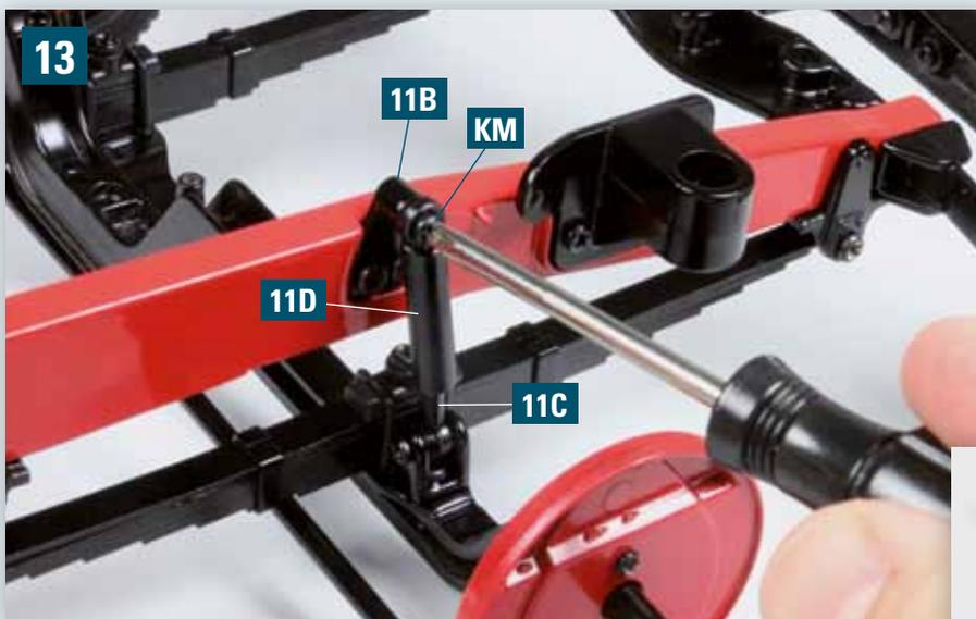
Fügen Sie die zweite Feder 11E in die zweite Stoßdämpfer-Buchse 11D ein (siehe Detailfoto). Stülpen Sie die Stoßdämpfer-Buchse 11D über den Stoßdämpfer-Zapfen 11C und drücken Sie den Stoßdämpfer leicht zusammen. Befestigen Sie den Stoßdämpfer mit einer Schraube KM am oberen Lagerbock 11B.
