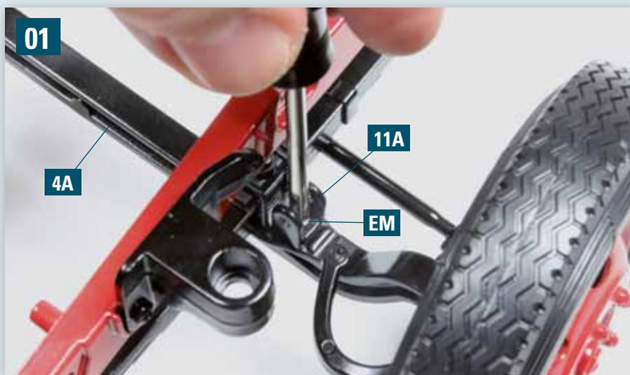
Befestigen Sie den ersten unteren Lagebock 11A mit einer Schraube EM am linken Ende der Vorderachse 4A.
