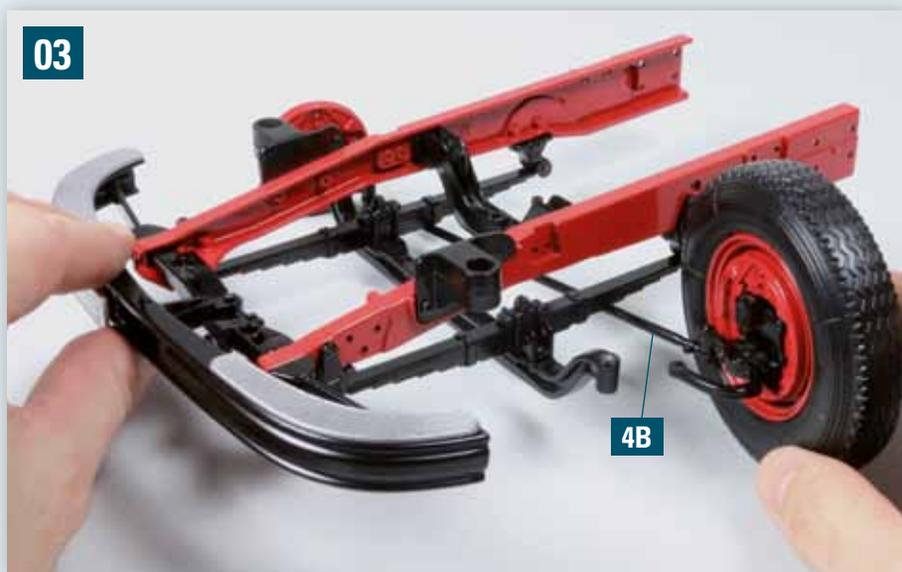
Das Vorderrad ist jetzt nur noch über die Spurstange 4B mit der Achse verbunden und kann zur Seite geklappt werden.
