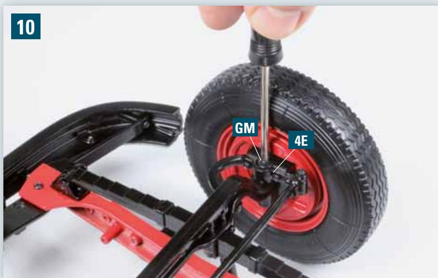
Anschließend drehen Sie den Rahmen um und ziehen an der Unterseite des Achsschenkels 4E eine Schraube GM fest.
