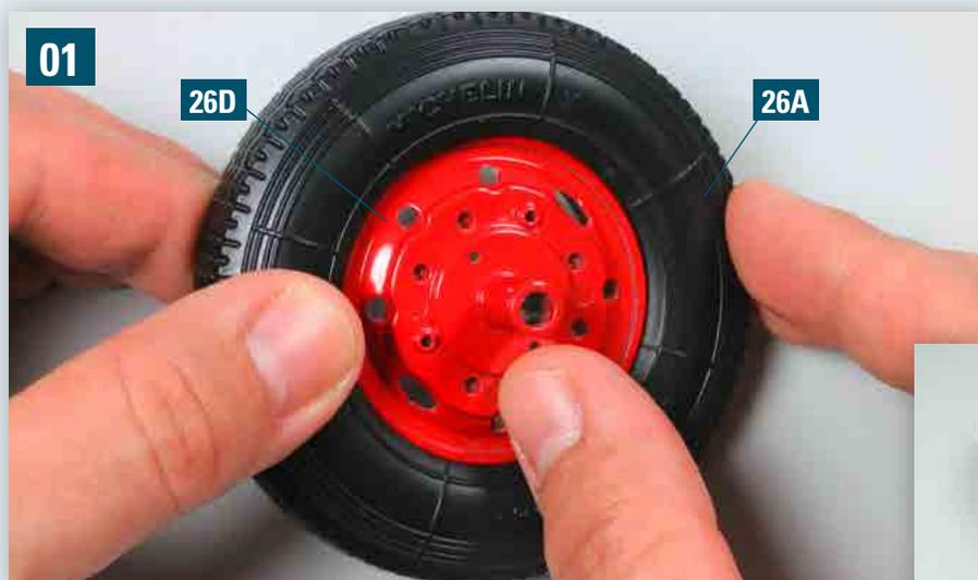
Nehmen Sie den äußeren Hinterreifen 26A und legen Sie ihn für etwa eine Minute in ein geeignetes Gefäß mit heißem Wasser (siehe Detailbild). Den abgetrockneten Reifen stülpen Sie über die Zapfen des Scheibenrads 26D.
