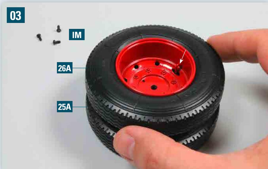
Fügen Sie die beiden rechten Hinterräder zusammen. Führen Sie dabei die Ventilverlängerung 26E (Pfeil) vorsichtig durch die ovale Bohrung des Scheibenrads 26D. Das Foto zeigt die aufeinander aufgesetzten Hinterräder. Legen Sie drei Schrauben IM bereit.
