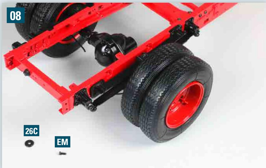
Das Foto zeigt die aufgesetzten rechten Hinterräder. Legen Sie die Unterlegscheibe 26C und eine Schraube EM bereit.
