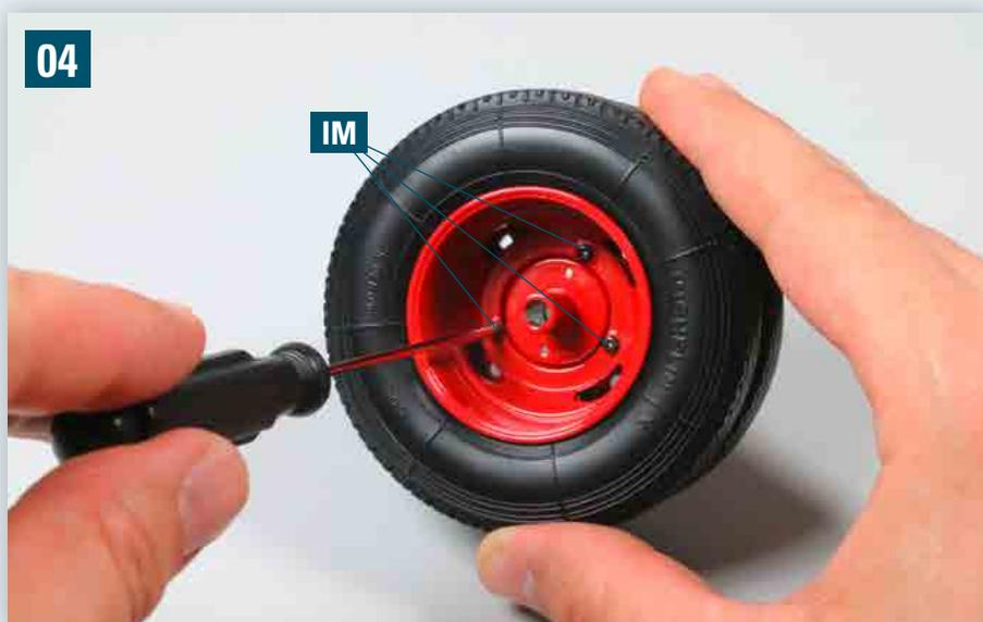
Drehen Sie die beiden Hinterräder um und ziehen Sie die drei Schrauben IM fest, wie es das Foto zeigt.
