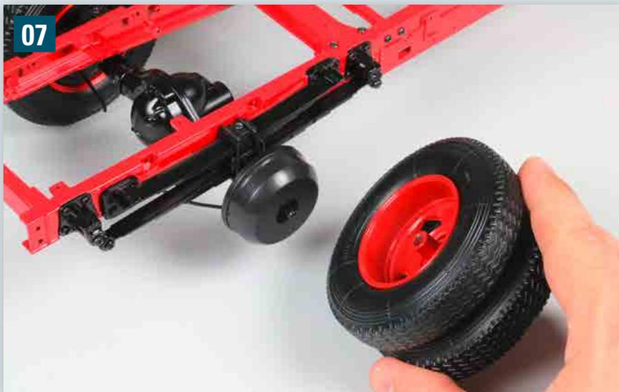
Setzen Sie die rechten Hinterräder auf der Trommelbremse bzw. der Hinterachse auf, wie angedeutet.
