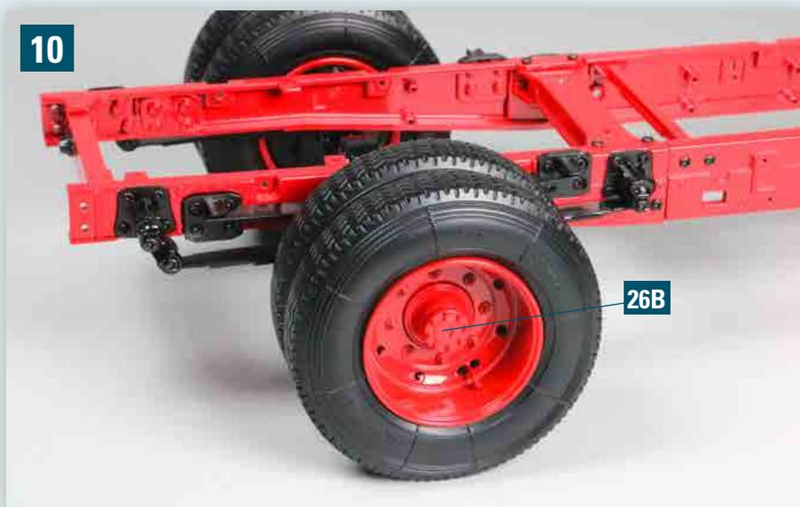
Setzen Sie über der Nabe des rechten äußeren Hinterrads die Radkappe 26B auf, indem Sie die zwei Zapfen in die zwei Bohrungen einfügen.
