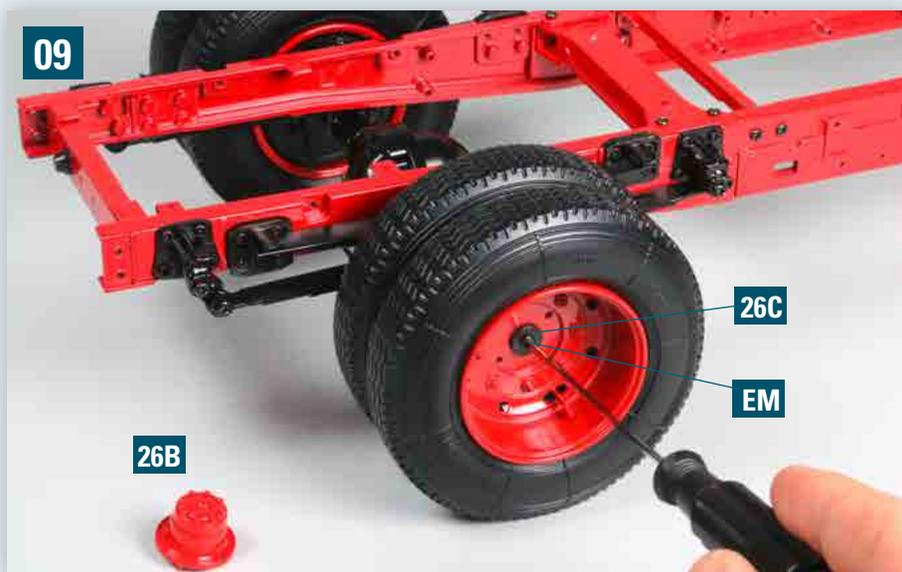
Legen Sie an der Nabe des Scheibenrads die Unterlegscheibe 26C auf und befestigen Sie die Hinterräder mit der Schraube EM an der Hinterachse. Legen Sie die Radkappe 26B bereit.
