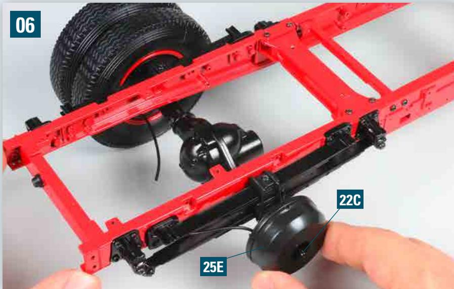
Setzen Sie die rechte Trommelbremse 25E auf die Hinterachse 22C auf, wie abgebildet. Achten Sie darauf, dass die Bremsleitung 26F nach hinten geführt wird.
