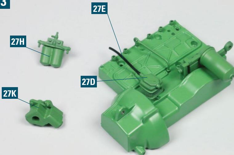
Setzen Sie den Schlauch 27E auf dem Zapfen der Luftpresser-Abdeckung 27D auf, wie es das Foto zeigt. Die Lenkhilfpumpe 27K und der Kraftstofffilter 27H werden erst mit der nächsten Bauanleitung am Motor befestigt.
