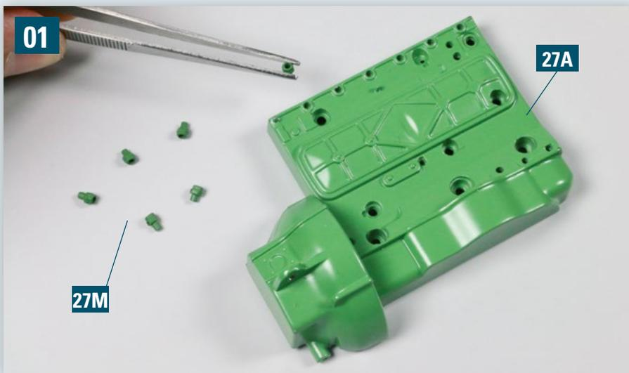
Legen Sie die rechte Motorhälfte 27A und die sechs Düsenhalter 27M auf Ihre Arbeitsplatte. Fügen Sie die Düsenhalter in die sechs kleinen Bohrungen am Motorblock ein. Weiten Sie die Bohrungen zuvor gegebenenfalls mit einem kleinen Handbohrer.
