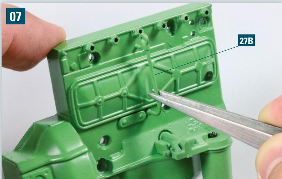
Setzen Sie den Ölmesstab 27B am Motorblock ein, wie es das Foto zeigt.
