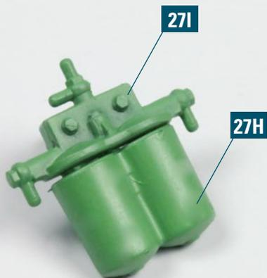
Setzen Sie den Gehäusedeckel 27I auf den Kraftstofffilter 27H. Die Ausrichtung des Deckels ist durch die unterschiedliche Zapfengröße vorgegeben.
