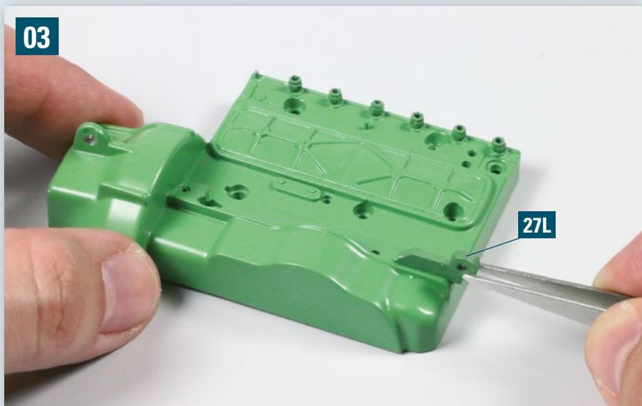
Befestigen Sie die Führungsplatte 27L, indem Sie deren zwei Zapfen in die entsprechenden Bohrungen des Motorblocks einfügen.
