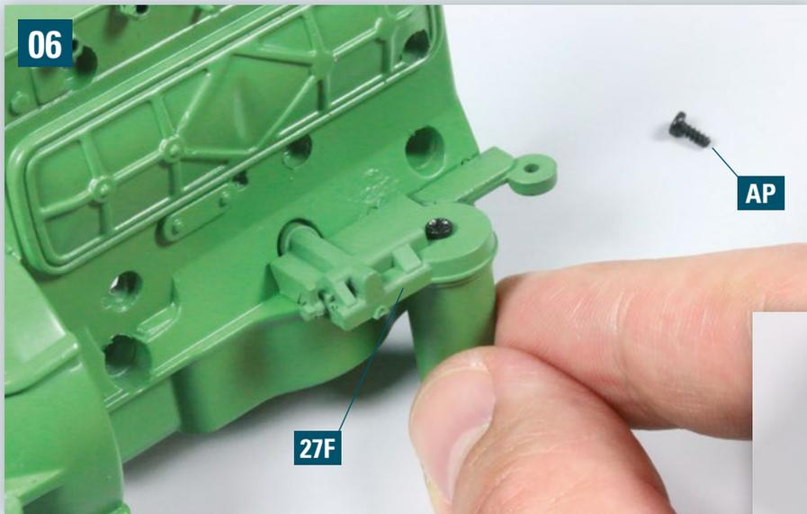
Fügen Sie die Aufnahme des Ölfilterdeckels 27F in die entsprechende Bohrung des Motorblocks ein und legen Sie eine Schraube AP bereit. Ziehen Sie die Schraube AP von der Innenseite des Motorblocks fest (siehe Detailbild).
