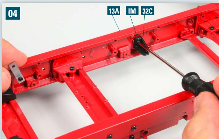
Wir bleiben auf der linken Rahmenseite und wandern noch etwas weiter in Richtung Heck: Befestigen Sie den Träger 32C mit einer Schraube IM in der Vertiefung am Längsträger 13A, wie es das Foto zeigt.
