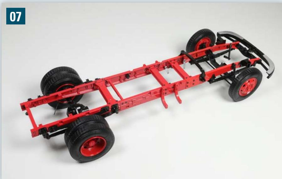
Der Baufortschritt in der Übersicht: An der rechten Rahmenseite sind die beiden Konsolen für den Kraftstoffbehälter angebracht, an der linken Seite die Konsolen für den Druckluftbehälter sowie zwei Halter und ein Träger.
