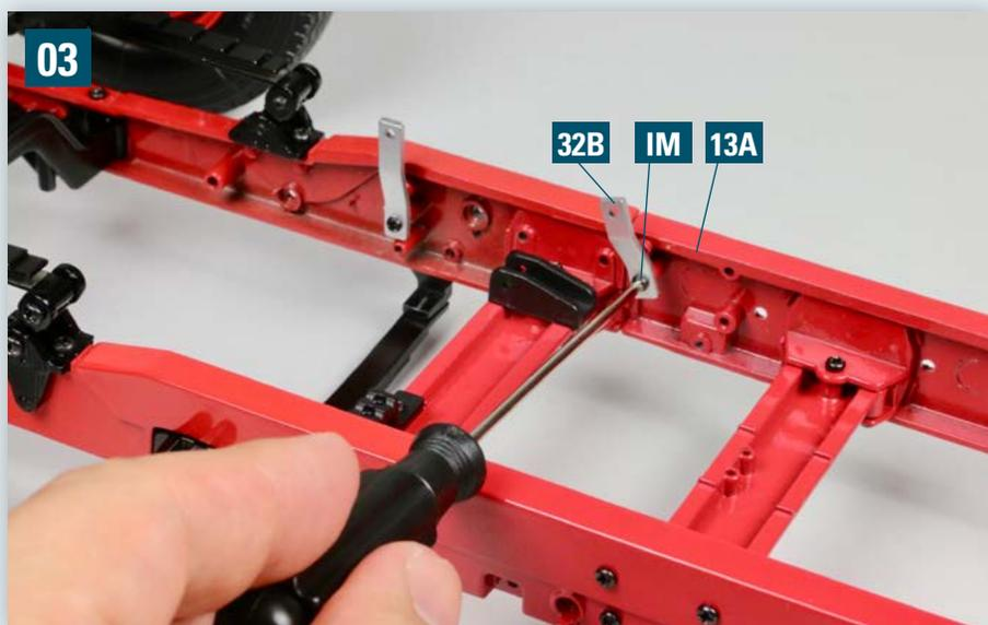
Der zweite Halter 32B wird etwas weiter hinten am Rahmen, nämlich am linken, mittleren Längsträger 13A, mit einer Schraube IM fixiert.
