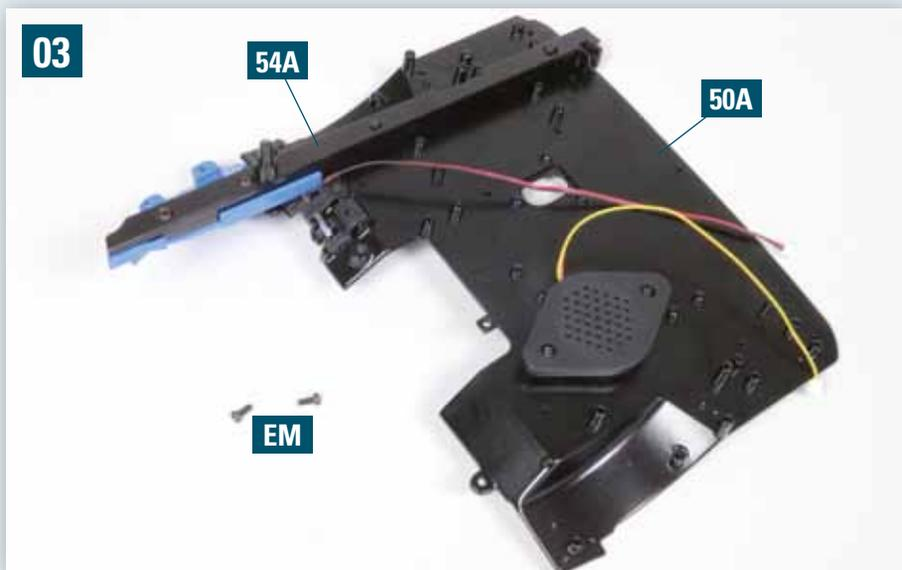
Nehmen Sie die Bodenplatte 50A und drehen Sie sie auf den Kopf. Positionieren Sie den Längsträger 54A so, wie es das Foto zeigt: Seine beiden Bohrungen nehmen die Zapfen der Bodenplatte auf. Legen Sie zwei Schrauben EM bereit.
