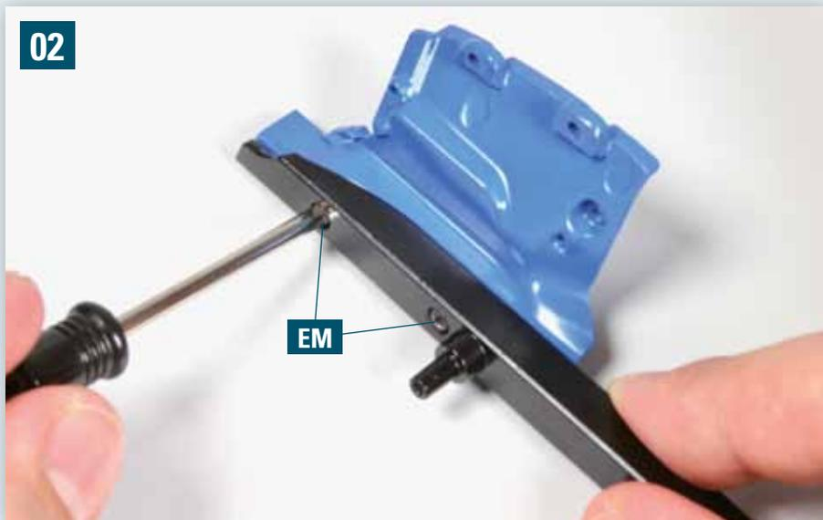
Befestigen Sie das Vorbau-Innenblech mit den beiden Schrauben EM am Längsträger.
