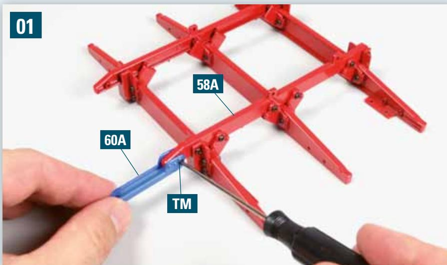
Richten Sie die Struktur des hinteren Pritschen-Unterbaus aus, wie es das Foto zeigt. Nehmen Sie eine der beiden Streben 60A und befestigen Sie sie mit einer Schraube TM am linken hinteren Längsträger 58A.
