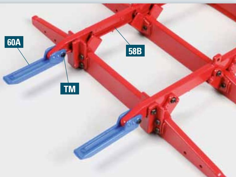
Die zweite Strebe 60A befestigen Sie mit einer Schraube TM am rechten hinteren Längsträger 58B, wie es das Foto zeigt.
