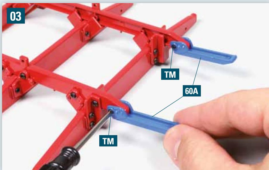
Befestigen Sie die beiden Streben auch von der anderen Seite mit jeweils einer Schraube TM an den beiden Längsträgern.
